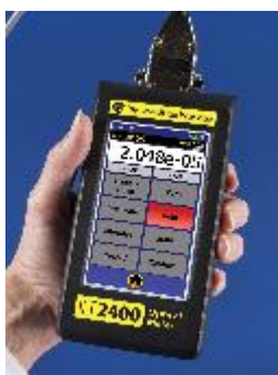
图 3: 带有相应探测器和滤光片的手持式 UV-C 辐射计。图片: 3a): Gigahertz-Optik 照度计; 3b): 国际 ILT 2400 UV-C 辐射计。图片来源: ILT。
