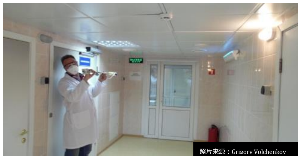
图 8：技术人员检查走廊里的视线水平紫外线安全性。
