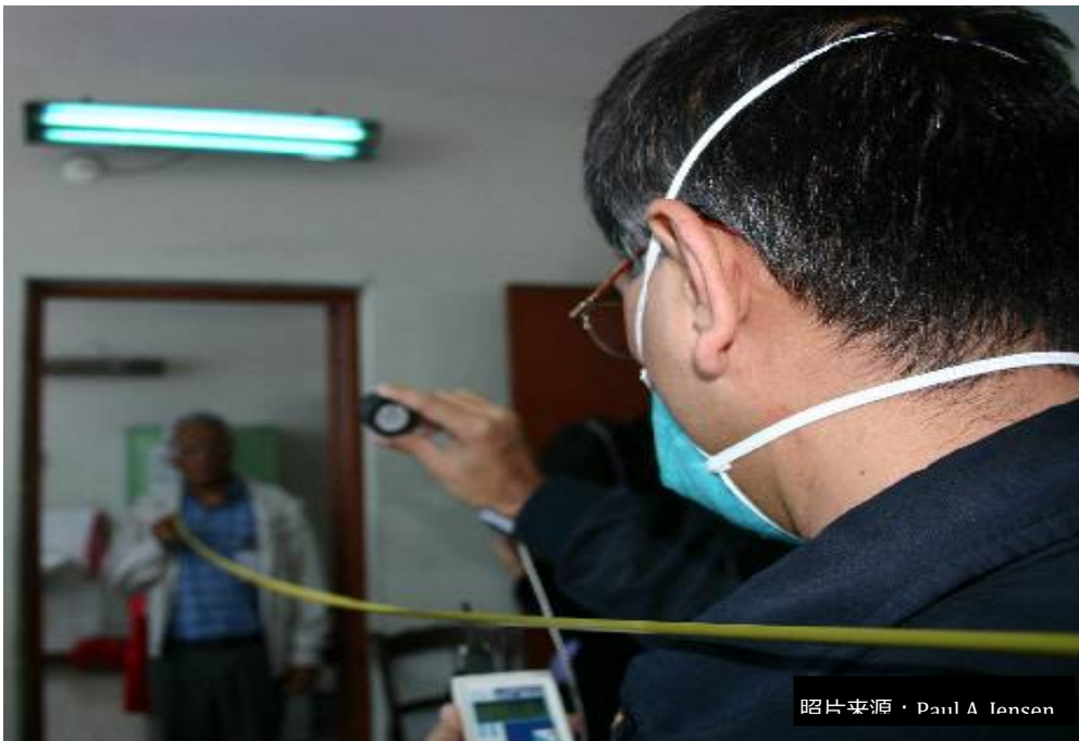
图 6：技术人员使用紫外线辐射计检查视线水平安全性。注意：蓝色可见光不是紫外线，只有辐射计才能准确测定紫外线。
