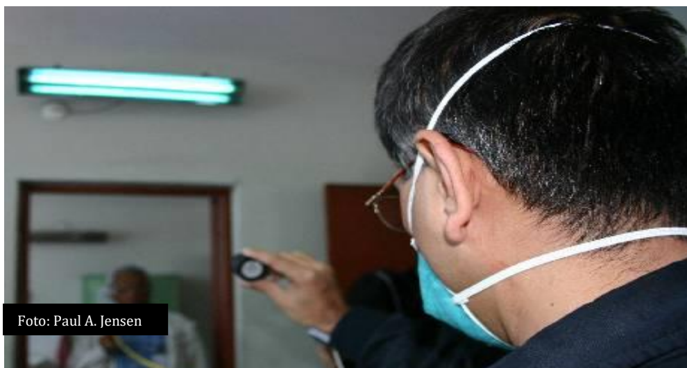
Figura 6 Técnico que revisa la seguridad a nivel de los ojos con radiómetro GUV LUVG. Nota: la luz visible azul no es GUV LUVG, solo el radiómetro puede evaluar el GUV LUVG con precisión.
