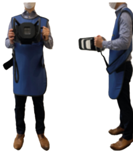
Tablier de protection en plomb (vue de face) Tablier de protection en plomb (vue latérale)
