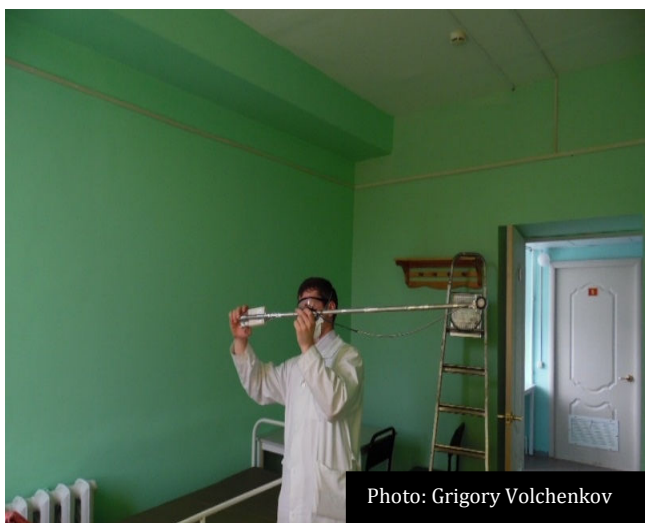
Рисунок 4 Техник использует БУФ радиометр для проверки безопасности для глаз. Обратите внимание: видимый голубой свет не является БУФ, уровень ультрафиолетового излучения можно оценить только радиометром.
