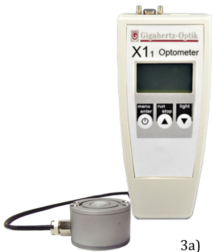
Рисунок 3. Портативный UV-C радиометр с детектором и фильтром. 3a) Gigahertz-Optik 3b) International ILT 2400 UV-C радиометр показан ниже. Фото: ILT.
