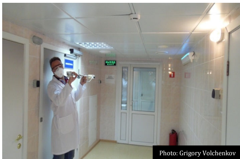
Рисунок 6. Техник измеряет облученность на уровне глаз в коридоре для оценки безопасности БУФ облучателей.
