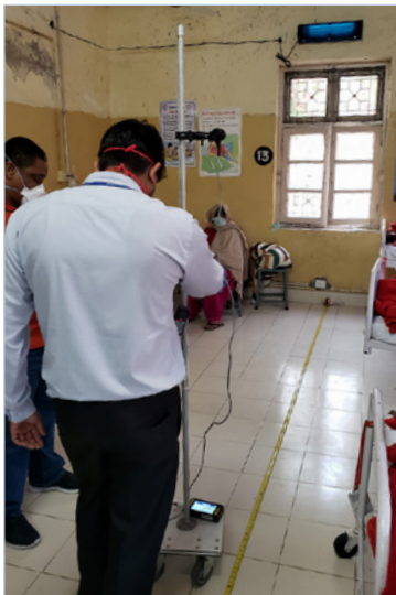
图 4 紫外线杀菌辐照计，其传感器安装在视线水平高度上
